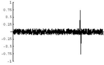
FIG. 71 – DPA effectuée avec succès (source : SERMA Technologies).
