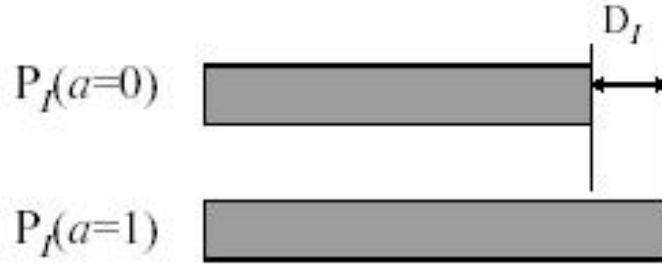
FIG. 70 – Dépendance de la consommation en courant de l'instruction I (source : SERMA Technologies).
