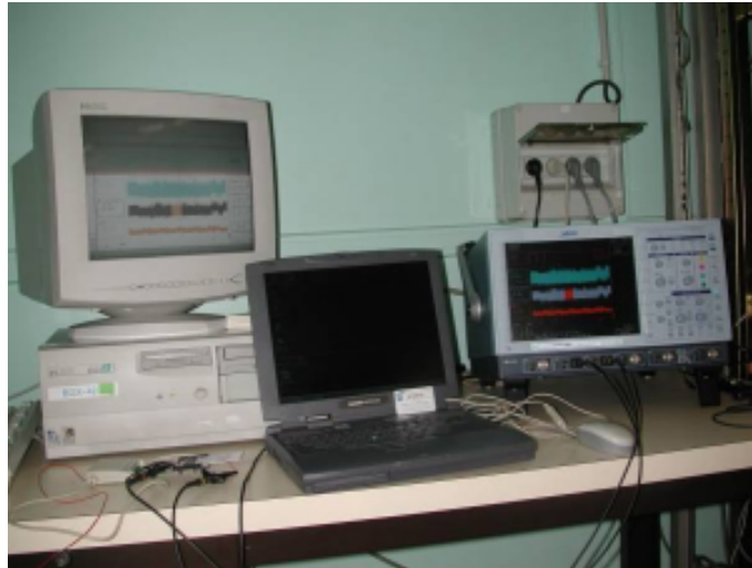
FIG. 63 – Une station d'étude de la consommation en courant (source : SERMA Technologies).
